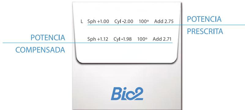
Al recibir una lente Bio2 con tecnología Digital Ray-Path 2® verá en su sobre dos potencias, la potencia prescrita y la potencia compensada. La potencia compensada es la que se mide en el frontofocómetro para comprobar que ha sido fabricada correctamente.
